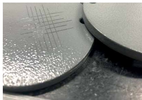
Após o processo de limpeza, com teste de grade grau zero
